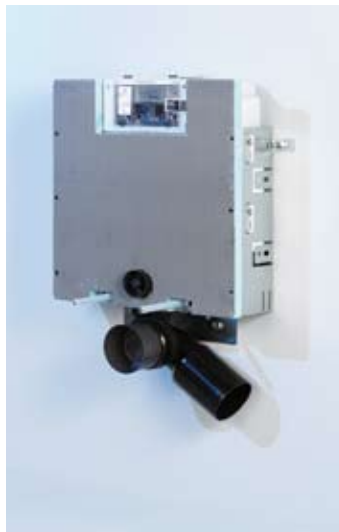
TECEbox-Nassbauspülkasten, 820 mm, in der Tiefe verstellbar. Je nach Monta- ge für die Betätigung von oben oder von vorn einsetzbar. Fliesenträger-Front aus 30 mm Bauplatte.
